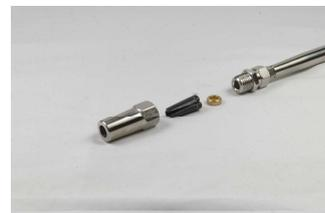
2 - L'extrémité du câble doit être coupé net et propre. Passez le dans la tête puis placez les pinces de part et d'autre du câble en le faisant dépasser de 2 à 3 mm
